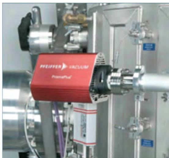
PrismaPlus™ на системе нанесения покрытия
