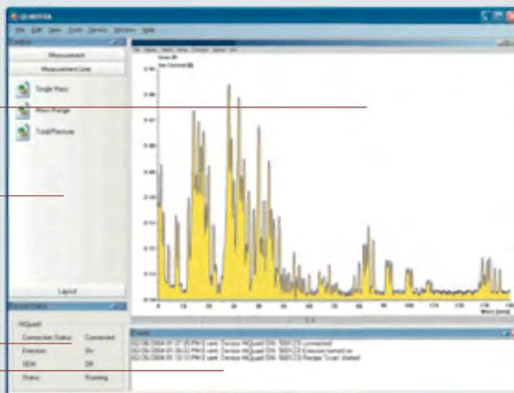
Данные измерений отображаются в центре экрана. Инструменты и связи, а также состояние устройства отображаются внизу слева. Важные сообщения отображаются в виде простого текста.
